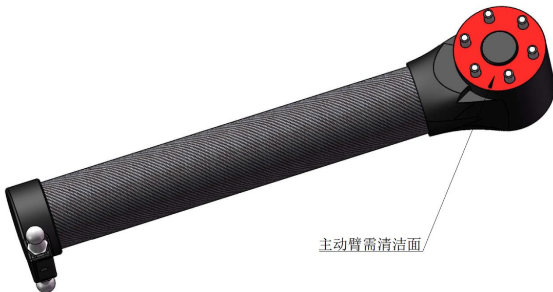
图 3-9 主动臂装配面示意图
